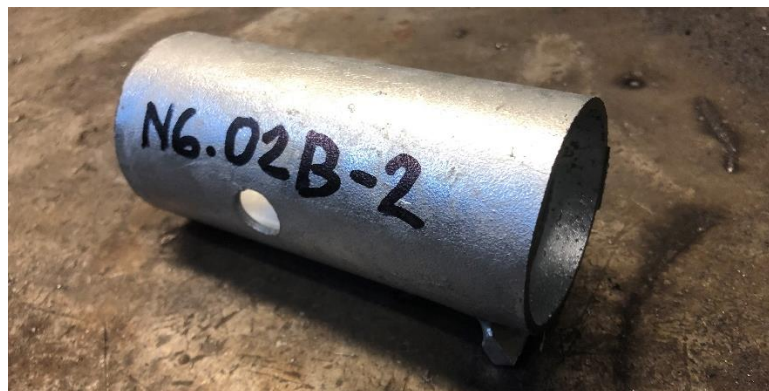
Obr. 5.1 Příprava polotovaru – řezání na pásové pile, připravený polotovar
