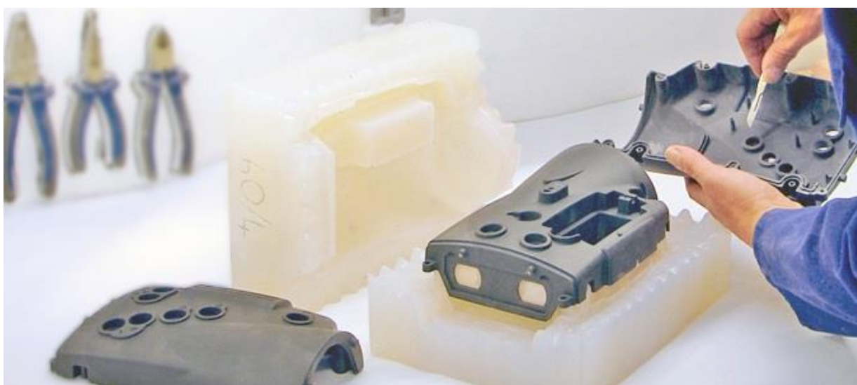
Obr. 1.7 Silikonová forma vyrobená metodou Soft Tooling [18]
