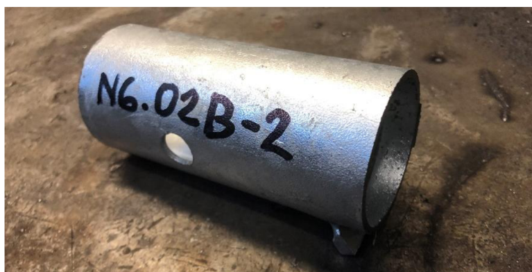
Obr. 5.1 Příprava polotovaru – řezání na pásové pile, připravený polotovar
