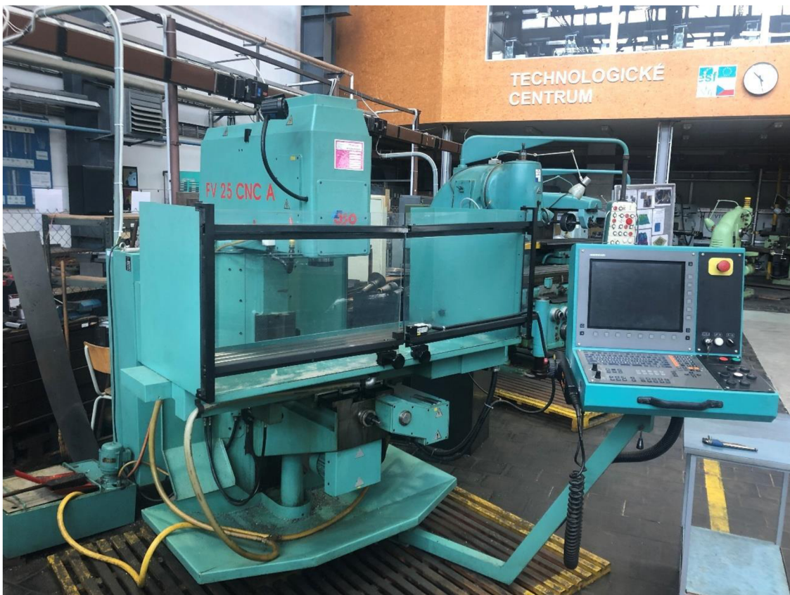
Obr. 5.2 Konzolová vertikální frézka FV 25 CNC A
