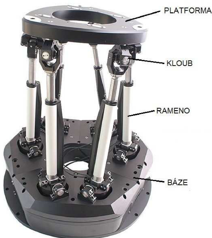
Obr. 16 Rozbor konstrukce PKS [15]
