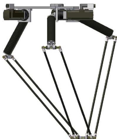
Obr. 17 Delta s neproměnnou délkou ramen [21]
