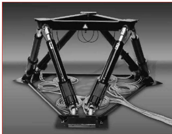
Obr. 18 Hexapod s proměnnou délkou ramen [20]
