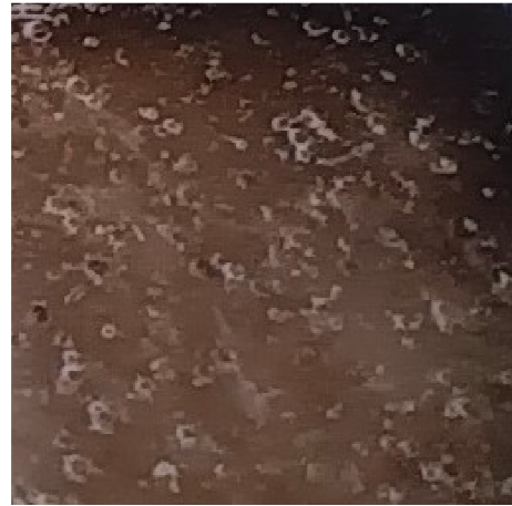
Obrázek 4.10: Výsledek po karbonizaci – čistý TEOS bez viditelného obsahu uhlíku Obrázek 4.11: Výsledek po karbonizaci – CD modifikovaný TEOS s evidentním obsahem uhlíku na povrchu
