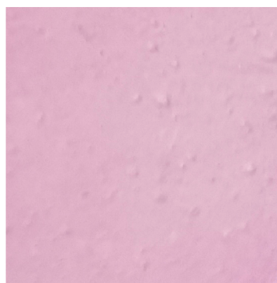
Obrázek 4.14: Povrch vláken s CD strukturou je stále růžový i po důkladném promytí vodou
