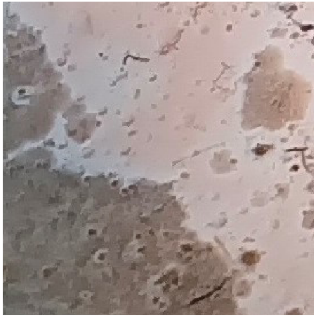
Obrázek 4.10: Výsledek po karbonizaci – čistý TEOS bez viditelného obsahu uhlíku Obrázek 4.11: Výsledek po karbonizaci – CD modifikovaný TEOS s evidentním obsahem uhlíku na povrchu
