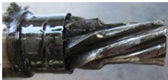
Obr. 21: Poškození pastorku [vytvořeno autorem]
