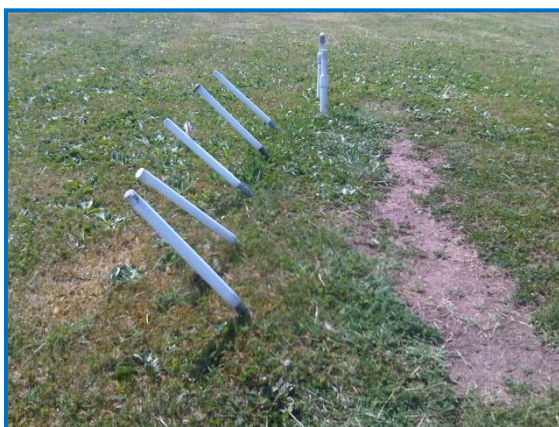
Obr. 57 Měření rtuťovými teploměry pod travnatým povrchem
