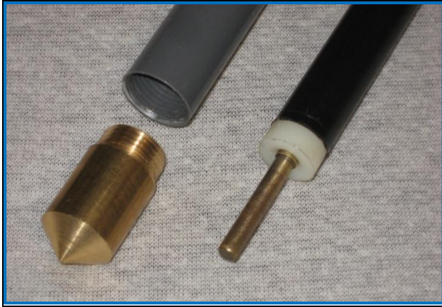
Obr. 6 Odporový teploměr (vpravo), pouzdro pro odporový teploměr s mosaznou čepičkou (vlevo)
