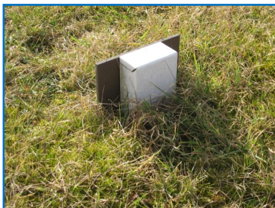
Obr. 59, 60 Viditelná část elektronického teploměru s ochranným pouzdrém
