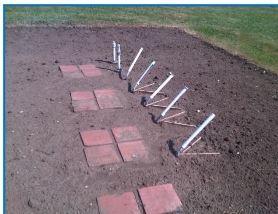
Obr. 58 Měření rtuťovými teploměry pod půdou bez porostu
