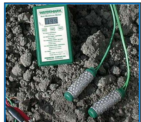
Obr. 12 Vlhkoměr založený na odporové metodě < http://www.ipm.iastate.edu/ipm/icm/2000/4-24-2000/evalsoilmoist.html >
