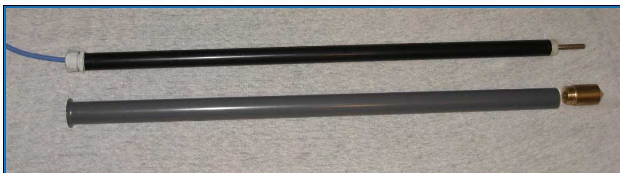
Obr. 5 Odporový půdní teploměr (nahore), pouzdro s mosaznou čepičkou (dole)
