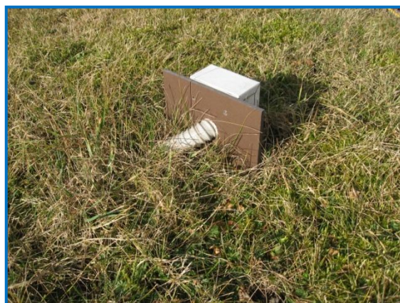
Obr. 59, 60 Viditelná část elektronického teploměru s ochranným pouzdrém
