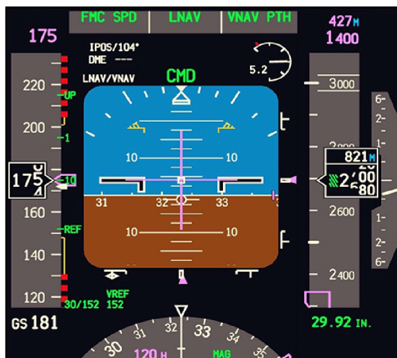
Obrázek 3.7: Primární letový displej [29]
