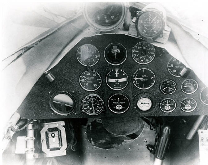
Obrázek 3.1: Přístrojová deska Consolidated NY-2 [21]
