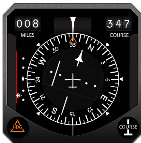
Obrázek 3.6: Indikátor horizontální situace [10]
