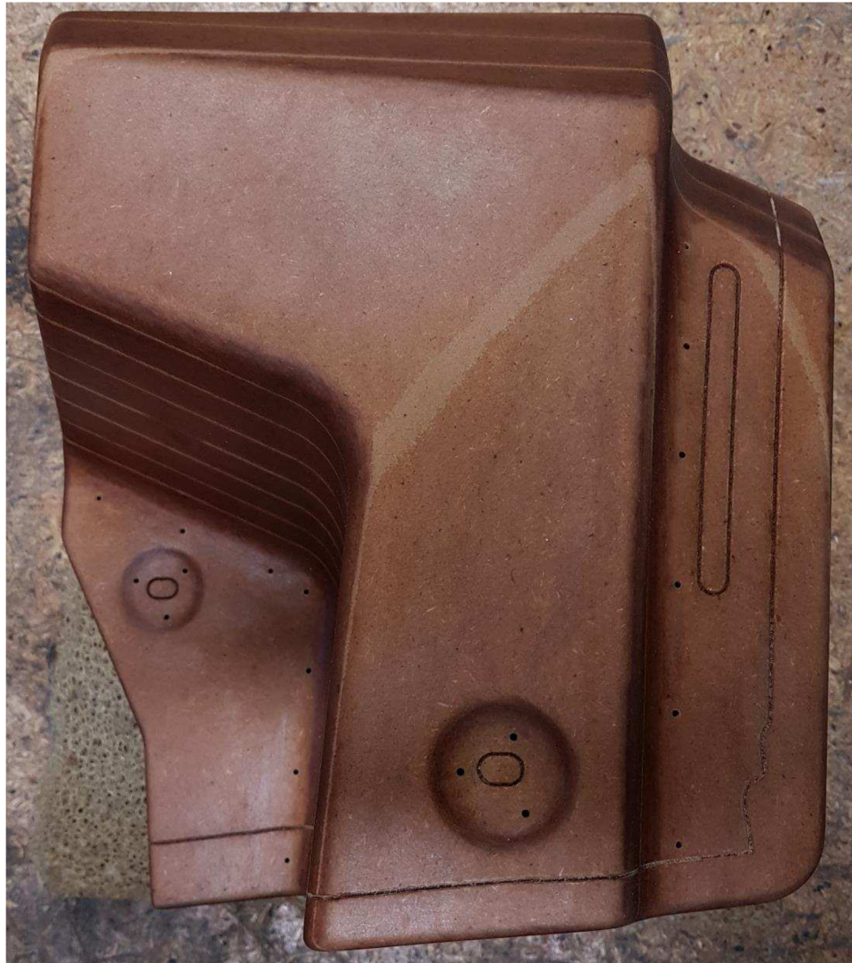
Obr. 2.33 Hotová forma s odvzdušňovacími kanálky.
