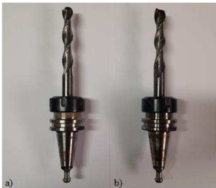
Obr. 2.7 Stopkové frézy, a) stopková kulová fréza D = 16 mm, b) stopková kulová fréza D = 16 mm.
