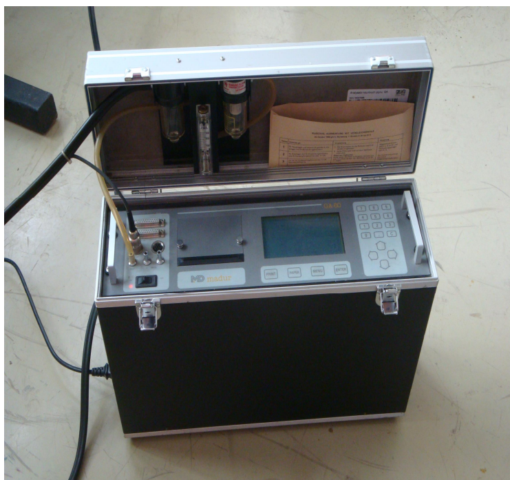
Obr. 11 Analyzátor vlhkosti Madur GA-60 a napojení analyzátoru do komína
