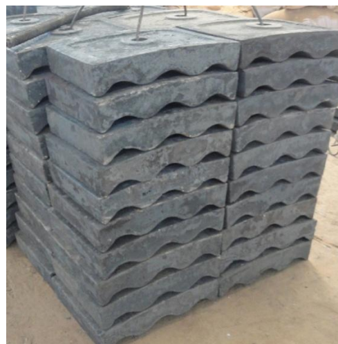
Obr. 70. Díly obložení kulového mlýnu z litiny s vysokých obsahem chromu. [45]
