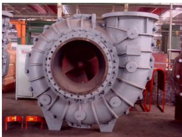
Obr. 73. Těleso čerpadla z legované bílé litiny. [50]
