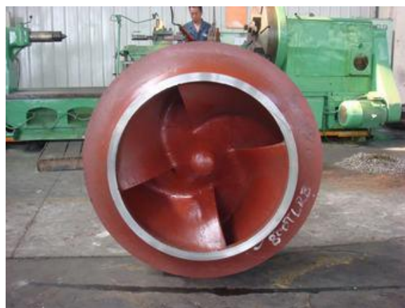
Obr. 74. Oběžné kolo čerpadla z legované bílé litiny. [50]
