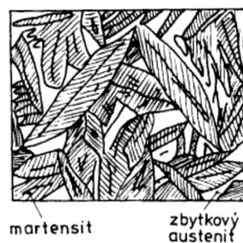
Obr. 33. Schéma rozmístění zbytkového austenitu v martenzitické struktuře. [6]
