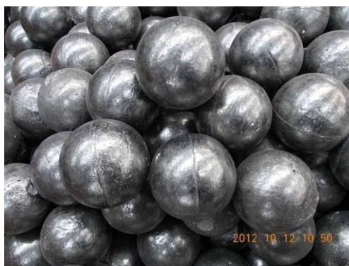
Obr. 69. Mlecí koule z litiny s vysokým obsahem chromu. [44]
