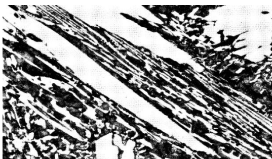
Obr. 37. Struktura nadeutektické litiny X 410 Cr 18 v litém stavu.
