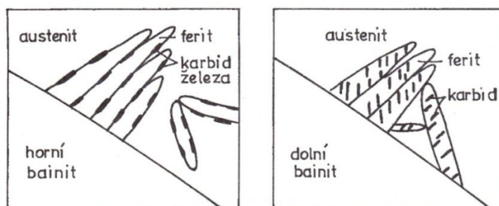
Obr. 28. Struktura horního bainitu (vlevo) a dolního bainitu (vpravo). [21]
