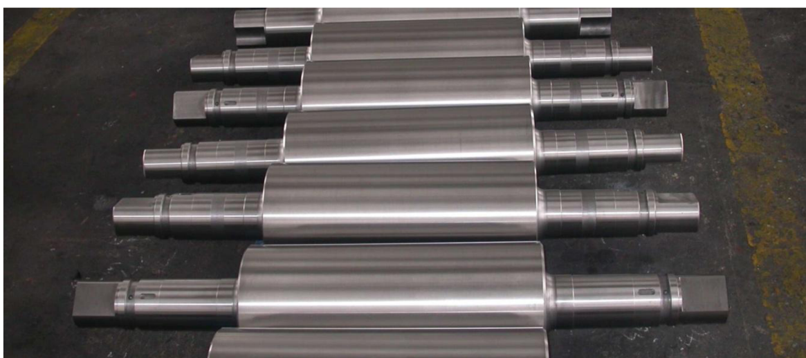
Obr. 68. Válce pro mletí a drcení z chromem vysoce legované bílé litiny. [43]
