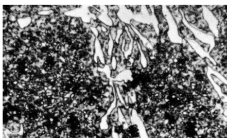
Obr. 47. Struktura bílé litiny X 265 Cr 13 po kalení na proudícím vzduchu. Rychlost ochlazování \approx \phi 20 mm. Matrice: 5% P + Ma + zA. ( \times 750 ) [10]
