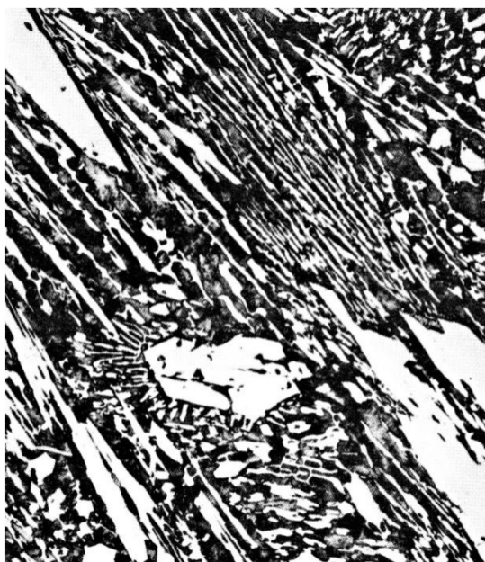
Obr. 34. Struktura bílé litiny X 410 Cr 15 v litém stavu. ( \times 150 ) [10]
