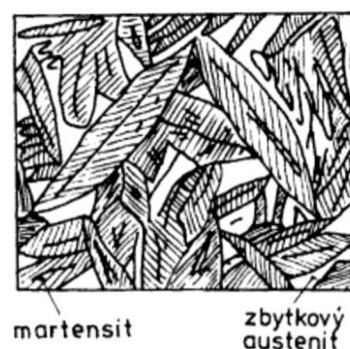
Obr. 33. Schéma rozmístění zbytkového austenitu v martenzitzické struktuře. [6]
