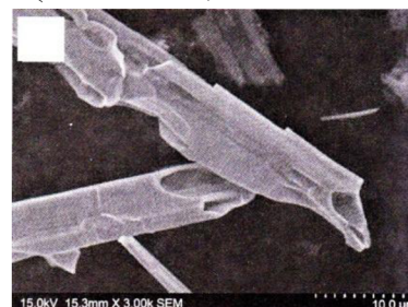
Obr. 19. Eutektické karbidy M_7C_3 s dutinami. [18]
