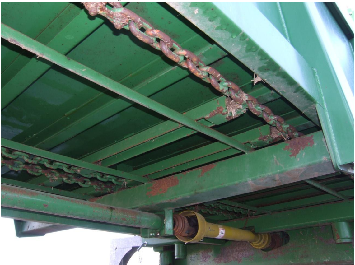
Obrázek 60: Vratná větev podlahového dopravníku
