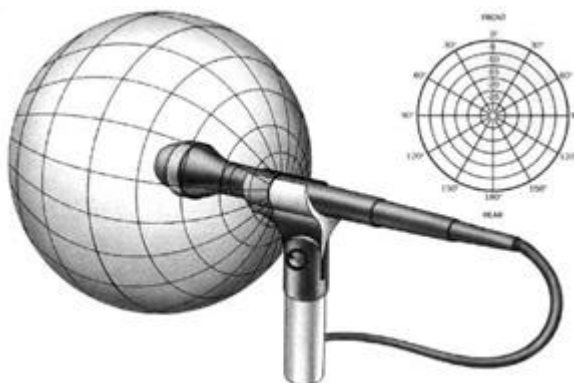
Obr. 2: Schéma snímání všesměrového mikrofonu [8]
