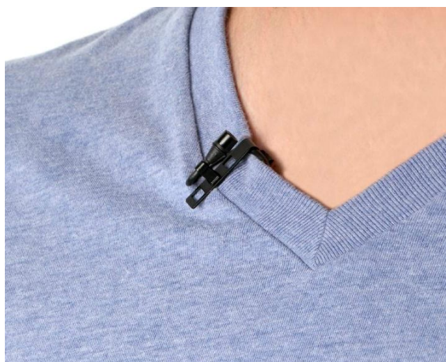
Obr. 19: Příklad umístění microportu (Shure MX150) [28]
