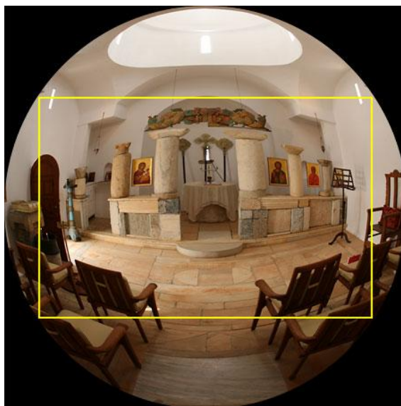
Obr. 78: Srovnání obrazu cirkulárního rybího oka a diagonálního rybího oka [89]
