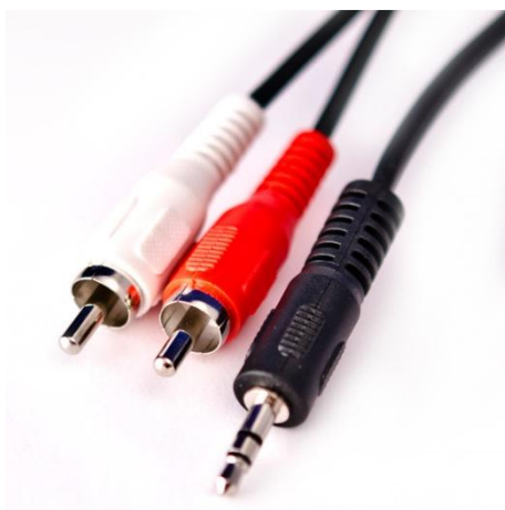
Obr. 32: Levý a pravý Cinch konektor; Jack 3,5 mm [39]
