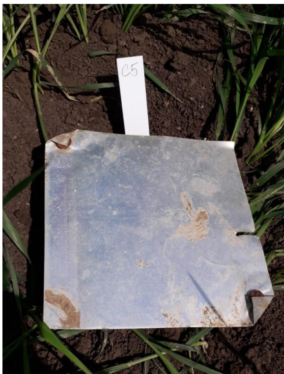
Obrázek 4 Zemní past zakrytá střechem
