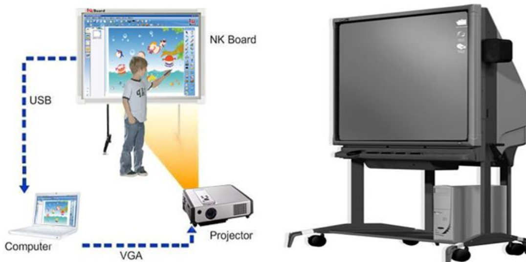
Obrázek 10- Interaktivní tabule: (zleva) s přední projekcí a se zadní projekcí (IqBoard, 2009)
