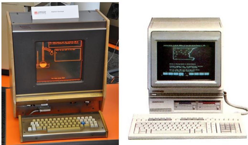
Obrázek 5- Dotykové zařízení: Zleva Plato IV a HP-150 (CommTech, 2011)
