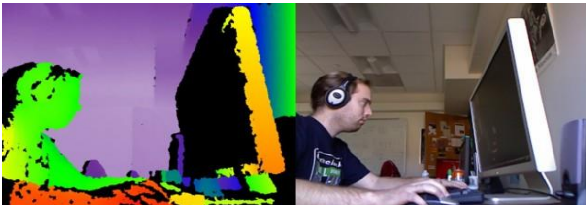
Obrázek 13- Kinect: Snímání hloubkovým senzorem (Fisher, 2014)
