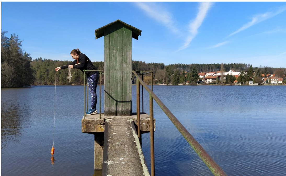
Obr. 8: Měření profilů na Jevanském rybníce, realizované z objektu výpustného zařízení. (Autor, 2020)
