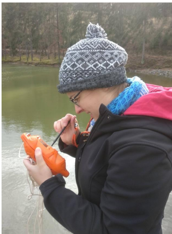
Obr. 3: CTD CastAway umožňuje prohlížení naměřených hodnot přímo na lokalitě. (Autor, 2020)
