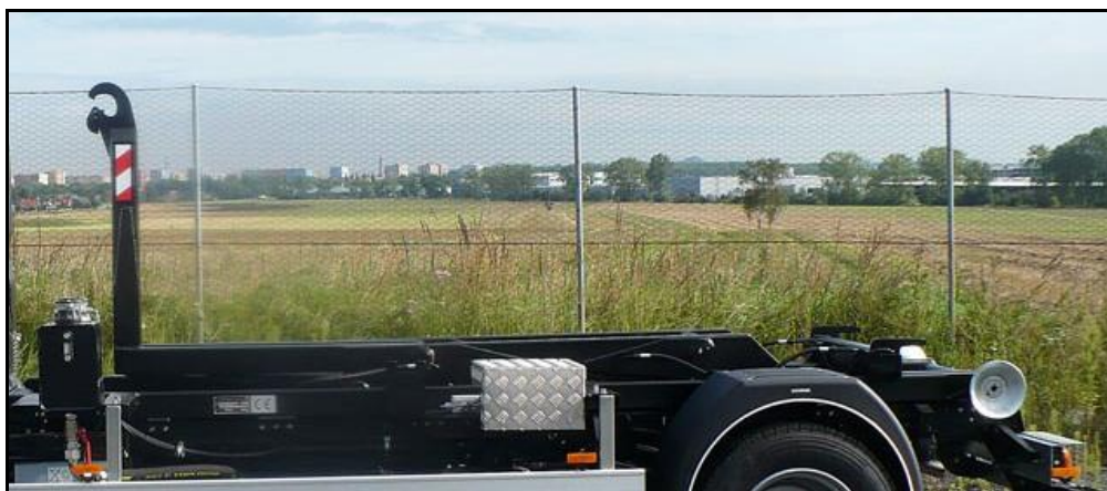
Obrázek 34 - Jednoramenný nosič kontejnerů CTS 5038 [32]
