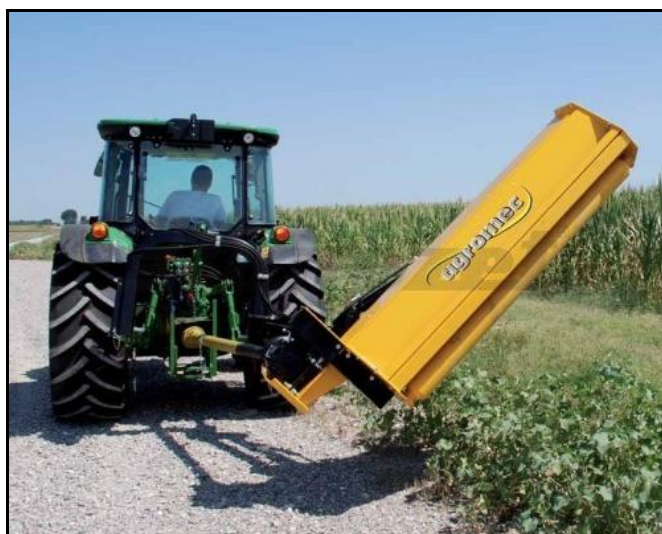
Obrázek 38 - Mulčovač Agromec AGO-P H 170 [25]
