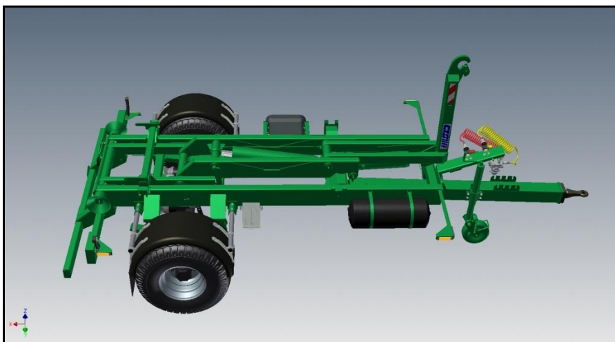
Obrázek 36 - Traktorový nosič kontejnerů TN CTS 05-32-K [32]
