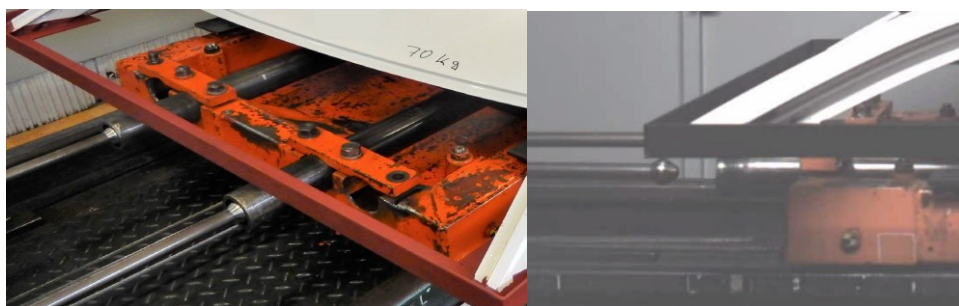
Obr. 3 Provedení bariéry s pryžovým deformačním členem
