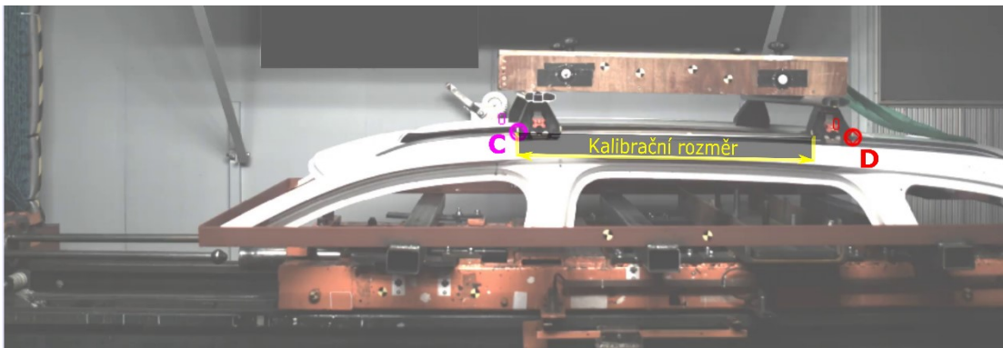
Obr. 10 Umístění sledovaných bodů na patkách, kalibračním rozměrem je rozteč patek
