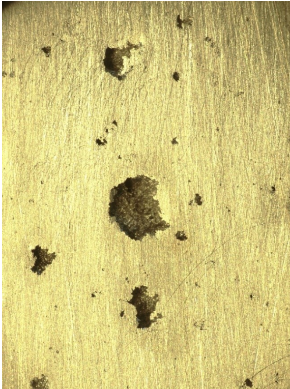
Obr. 23 Detail koroze na oceli 1.4309.
