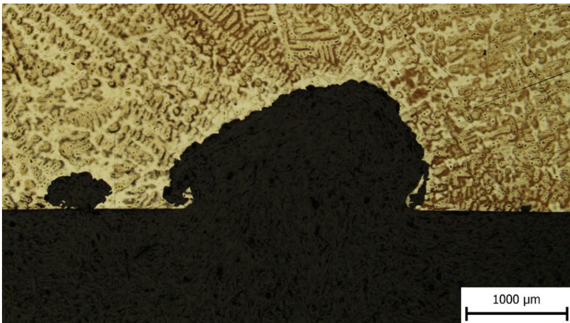
Obr. 31 Naleptaný vzorek austenitické oceli 1.4309 při zvětšení 25,6x.
