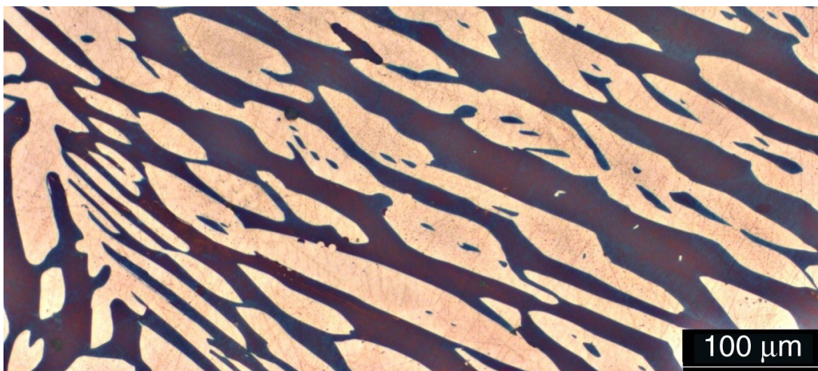
Obr. 8 Mikrostruktura lité duplexní oceli. [38]
