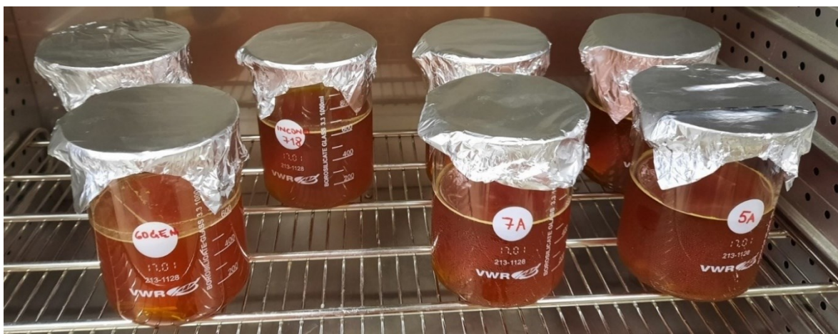
Obr. 19 Baňky se vzorky v klimatické komoře.
