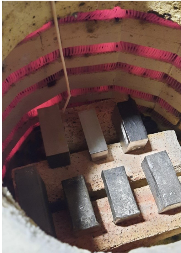
Obr. 15 Zkušební vzorky v průběhu rozpouštěcího žíhání.
