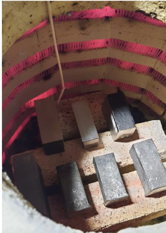
Obr. 15 Zkušební vzorky v průběhu rozpouštěcího žhání.
