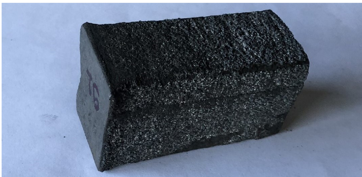
Obr. 14 Odlitý vzorek austenitické oceli.
