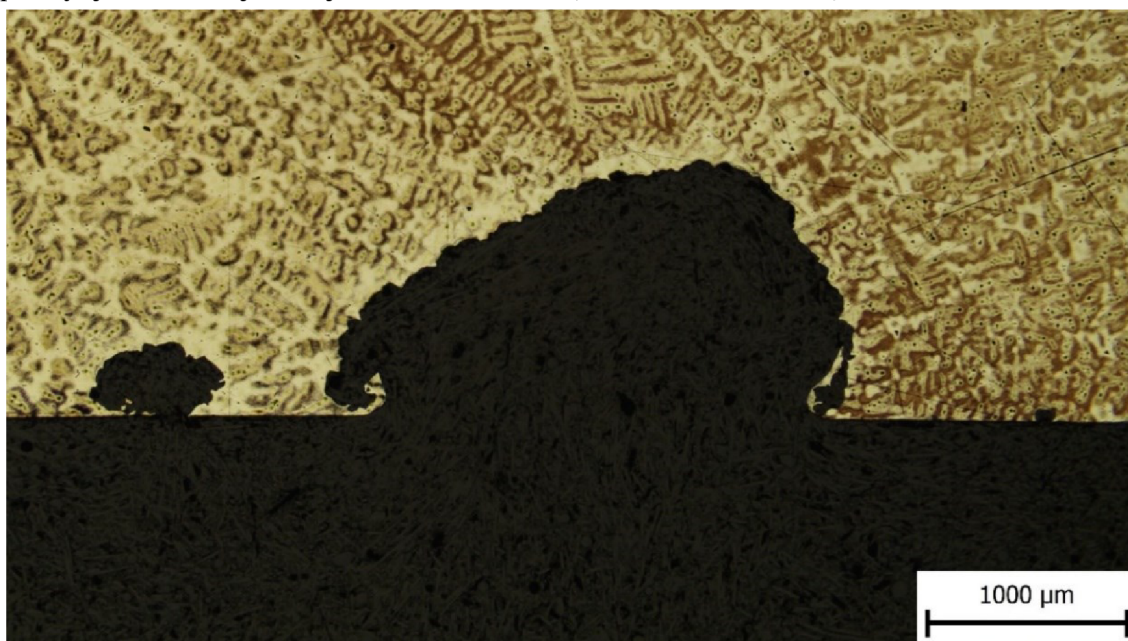
Obr. 31 Naleptaný vzorek austenitické oceli 1.4309 při zvětšení 25,6x.
