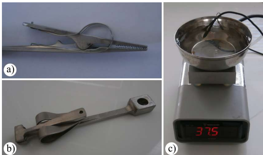
OBR. 5.3: a) Detail svorky pro biaxiální zkoušky, b) celkový pohled na svorku pro jednoosou tahovou zkoušku, c) externí vyhřívací lázeň pro vzorky během jejich zpracování.
