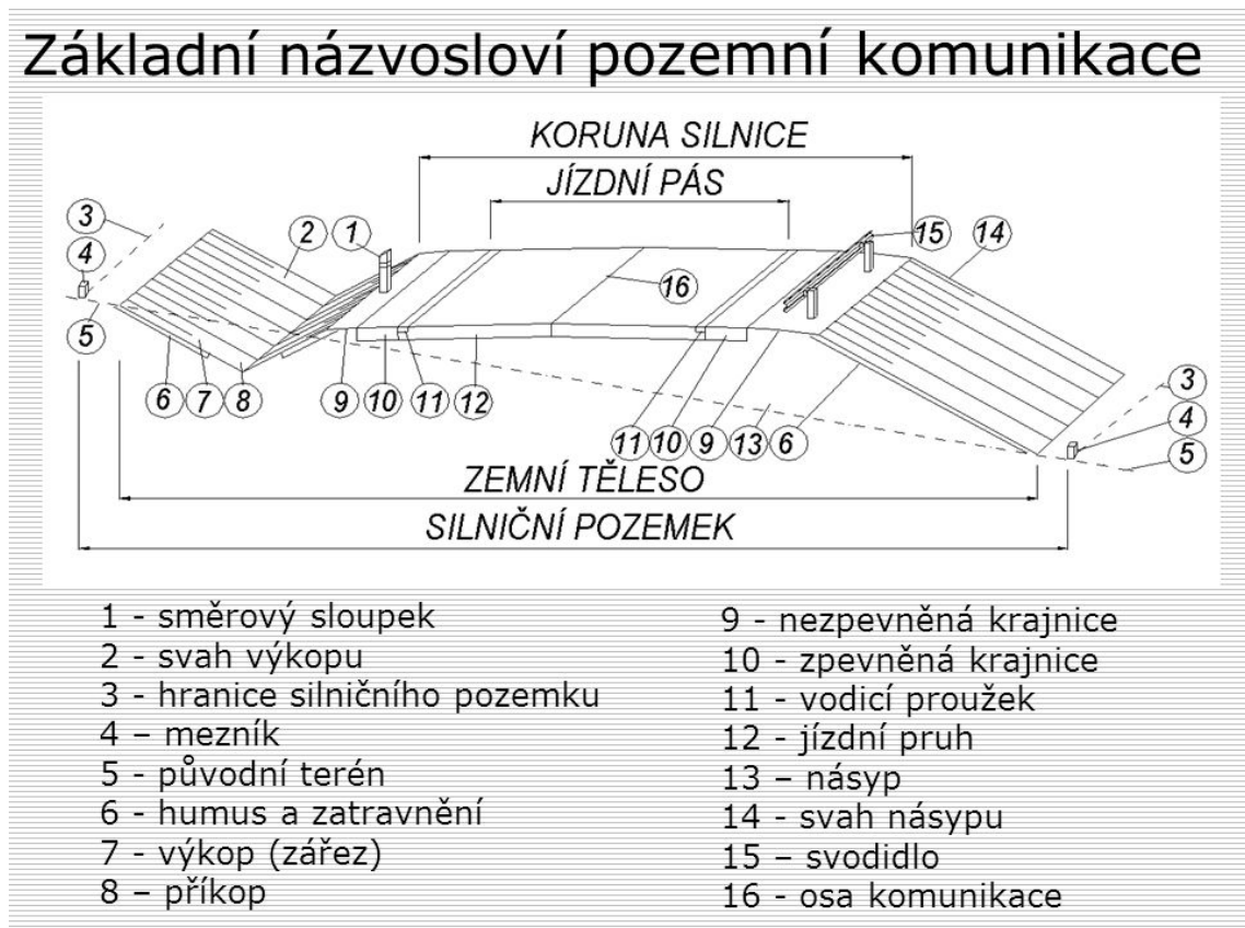
Obrázek 1.2 Konstrukce vozovky
