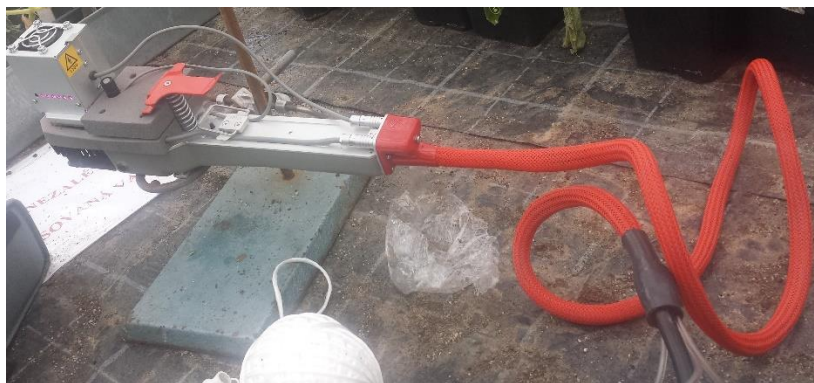
Obr. 12: Měřicí hlavička LCpro+ (foto autor)
