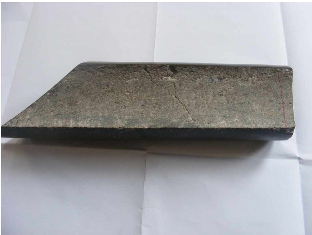
Obr. č. 2: Viditelné praskliny, potřebné pro oběh vody ve vrtech
