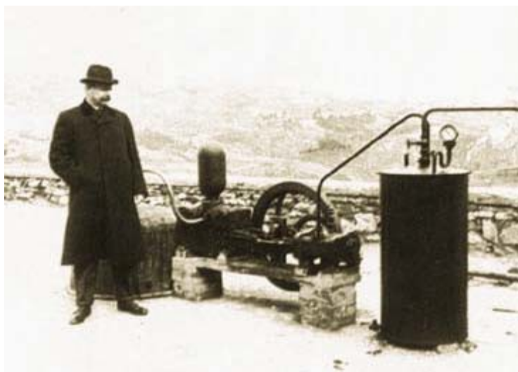
Obr. č. 1: Parní stroj použitý v Lardarello v roce 1904 při prvním experimentu výroby elektrické energie z geotermální páry ( na obrázku s vynálezcem Pierrem Ginori Conti) ( zdroj: Rybár, 2007)
