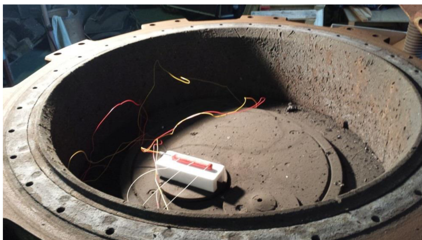
Obr. C.2: Příprava výbušniny Semtex pro měření
