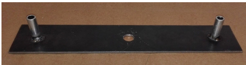
Obr. 5.2: Pohyblivá část lineárního vedení
