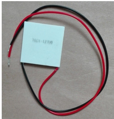
Obr. 6.4: Peltierův článek použitý pro realizaci chlazení a ohřevu
