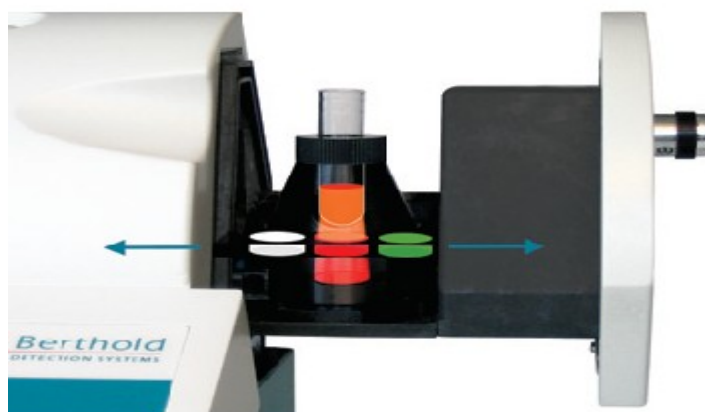
Obr. 13. Pozice filtrů v měřicí komoře
