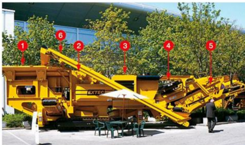
Kombinovaná recyklační linka se zpětným vedením nadsitné složky 1) násypka s předtříděčem 2) odrazový drtič 3) hnací agregát (spalovací motor) 4) magnetický separátor 5) vibrační tříděč 6) zpětný pás[8]
