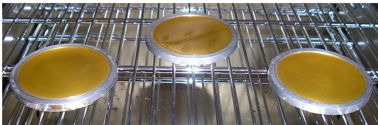
Obr. 18 Umístění forem v horkovzdušném sterilizátoru STERICELL 55
