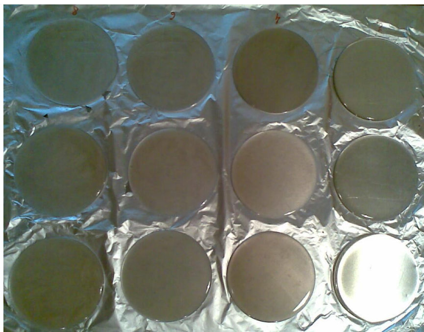
Obr. 9 Vytvrzené vzorky na hliníkových podložkách
