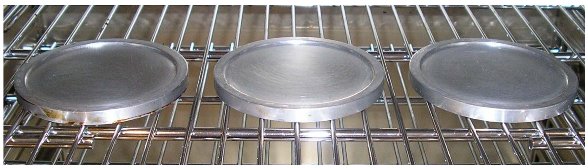
Obr. 12 Hliníkové formy předehřáté na teplotu 80 °C
