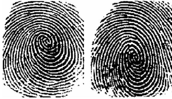
Obr. 1.7: Zkreslení v dotykovém snímači z důvodu jiných tlaků. Převzato z [9].
