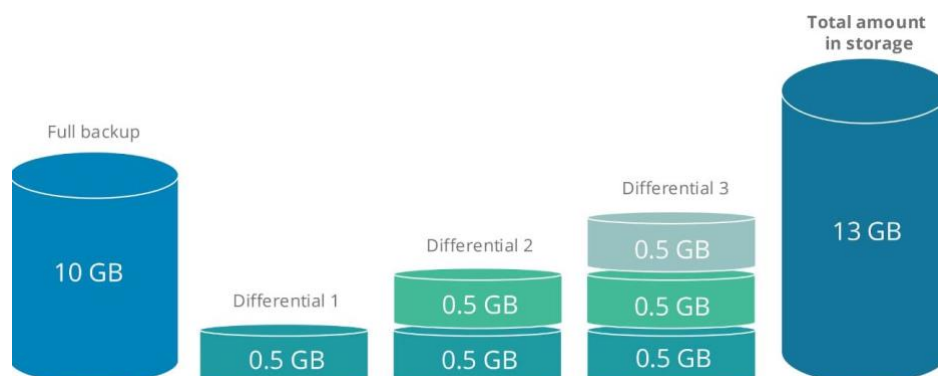
Obrázek 13 - Rozdílová záloha a využití místa v úložišti
