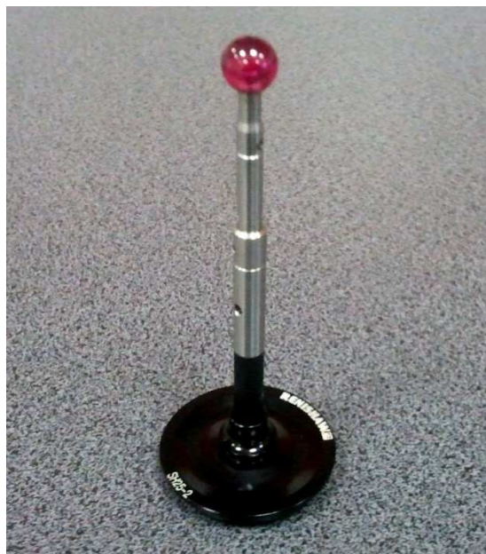
Obr. 6.7: Finální konfigurace snímacího doteku (foto autor DP)
