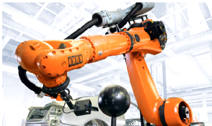
Obr. 5.7: Bezdotykové měření karoserie automobilu – řešení společnosti KUKA [61]
