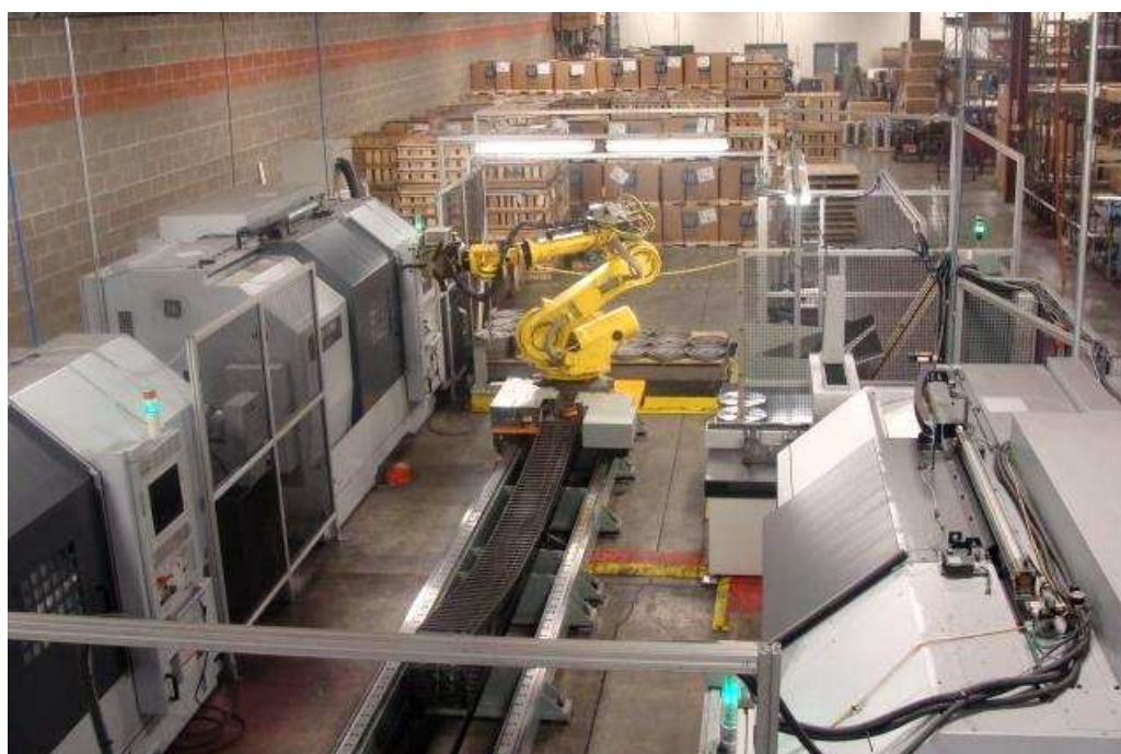
Obr. 5.2: Koncepte robotické buňky společnosti ACE obsahující CMM [35]
