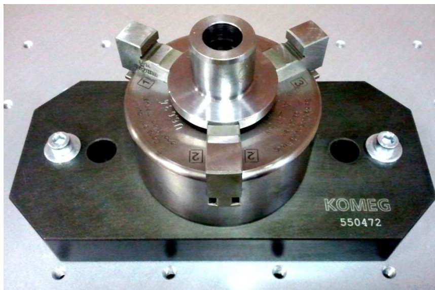
Obr. 6.3: Provizorní upínací přípravek – sklíčidlo (foto autor DP)
