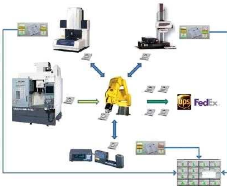
Obr. 5.1: Schéma automatizovaného měřicího pracoviště firmy Mitutoyo [64]
