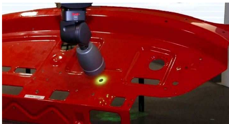
Obr. 3.14: Optické měření pomocí CMM-V [29] [62]
