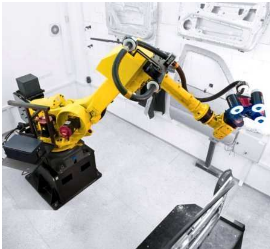
Obr. 5.6: Měření pomocí skeneru WLS400A – Hexagon Metrology [41]
