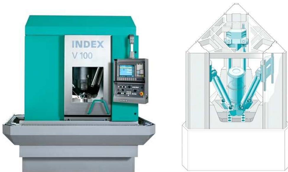
Obr. 2.5: INDEX-Werke V100 – stroj typu Linapod [21]
