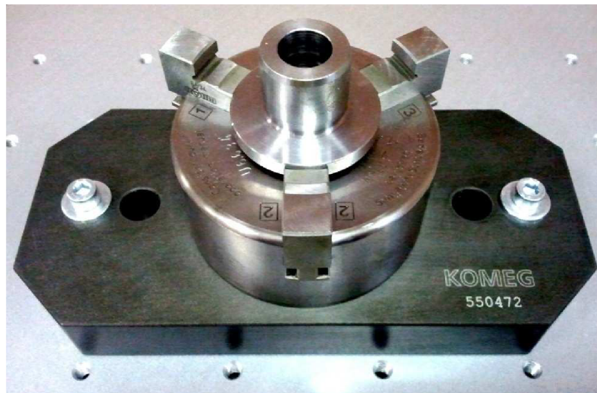
Obr. 6.3: Provizorní upínací přípravek – sklíčidlo (foto autor DP)
