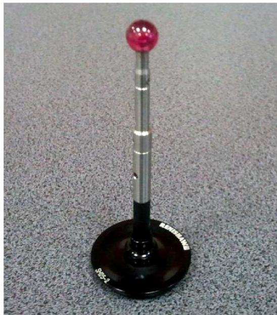
Obr. 6.7: Finální konfigurace snímacího doteku (foto autor DP)
