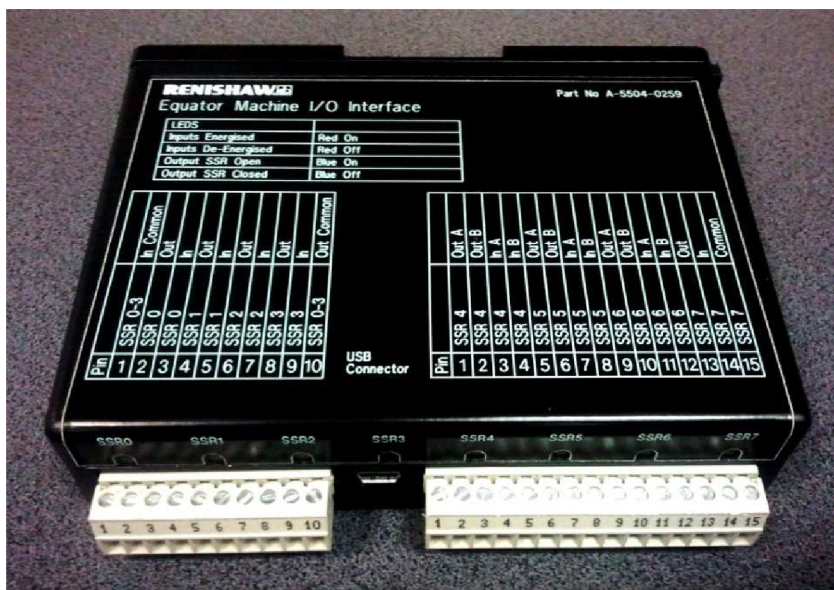
Obr. 7.1: Digitální I/O rozhraní pro Equator™ (foto autor DP)
