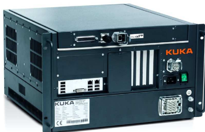
Obr. 5.11: Řídicí jednotka KR C4 compact [67]
