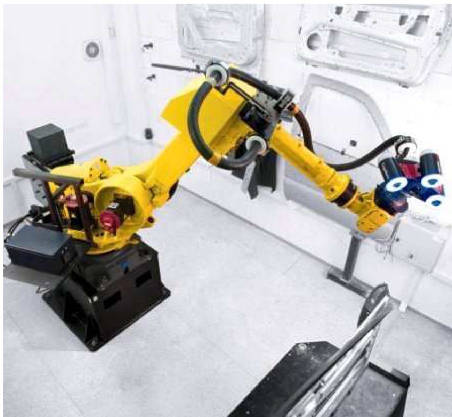
Obr. 5.6: Měření pomocí skeneru WLS400A – Hexagon Metrology [41]
