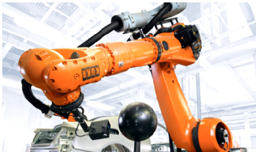
Obr. 5.7: Bezdotykové měření karoserie automobilu – řešení společnosti KUKA [61]
