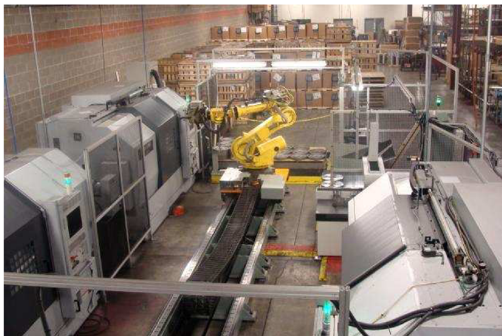
Obr. 5.2: Koncepte robotické buňky společnosti ACE obsahující CMM [35]
