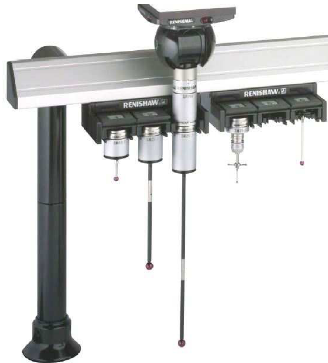
Obr. 3.13: Modulární systém Renishaw SP25M [60]
