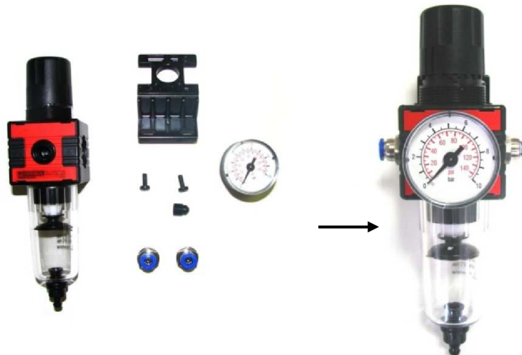
Obr. 9.7: Jednotka na úpravu stlačeného vzduchu (filtr, redukční ventil, manometr) před a po montáži (foto autor DP)
