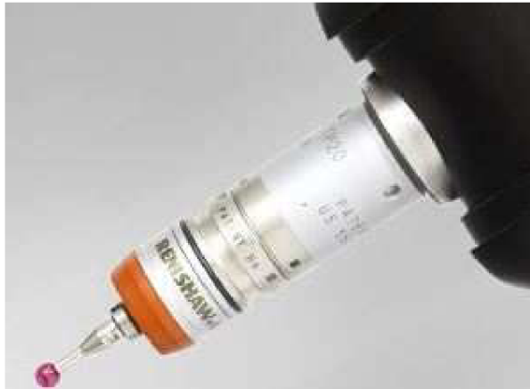
Obr. 3.11: Spínací doteková sonda Renishaw TP20 [1]
