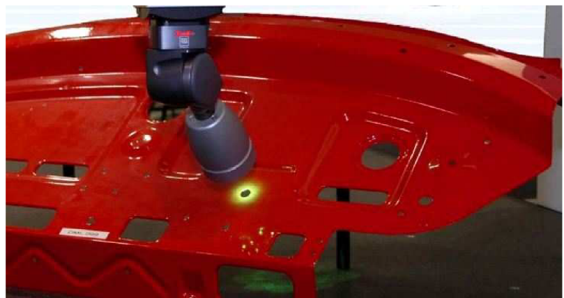
Obr. 3.14: Optické měření pomocí CMM-V [29] [62]
