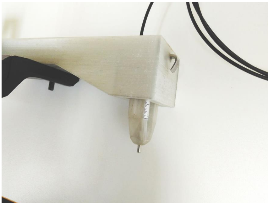
Obrázek 13: Prototyp pro upevnění optického kabelu v mikroskopu s možností adjustace v ose z. Foto autor.
