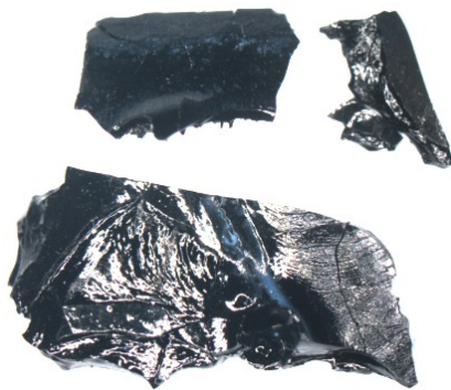
Obrázek 4.3: SiOC – polysiloxanová pryskyřice po pyrolýze [31].
