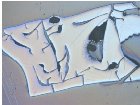
Obrázek 4.9: Povrch pryskyřice po vyleštění suspenzí 1 \mu\text{m} . Zvětšení 1200 \times (zorné pole 256 \times 192 \mu\text{m} ).
