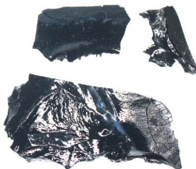
Obrázek 4.3: SiOC – polysiloxanová pryskyřice po pyrolýze [31].
