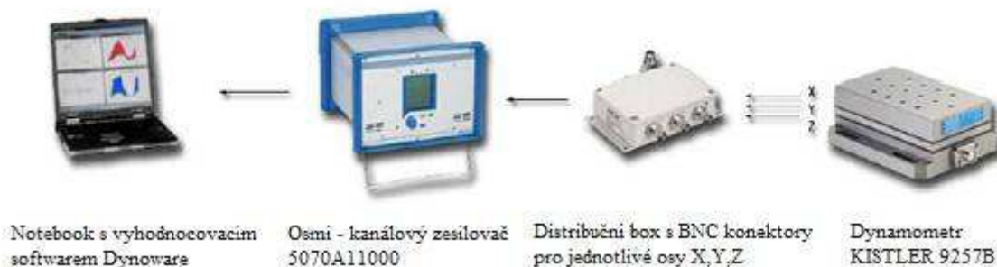
Obr. 2.22 - Schematické znázornění měřicí aparatury Kistler [24].
