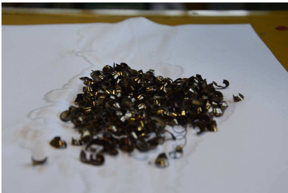
Obr. 2.24 - Vzniklá tříška při obrábění B_01_08 levým nožem při a_p = 3,0 mm a f = 0,30 mm.
