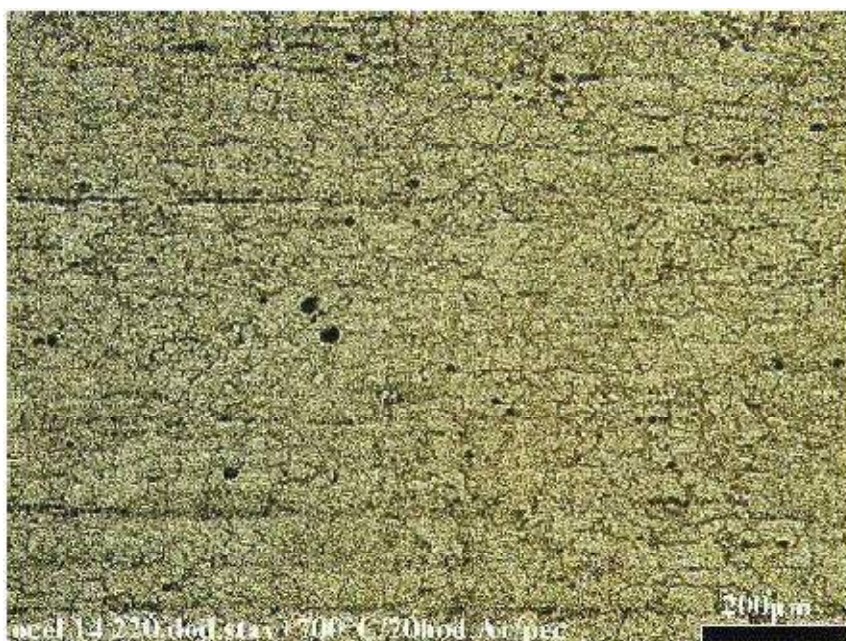
Obr. 2.3 - Struktura materiálu 16MnCr5 (14 220) po žihání na měkko, zvětšení 100x [11].
