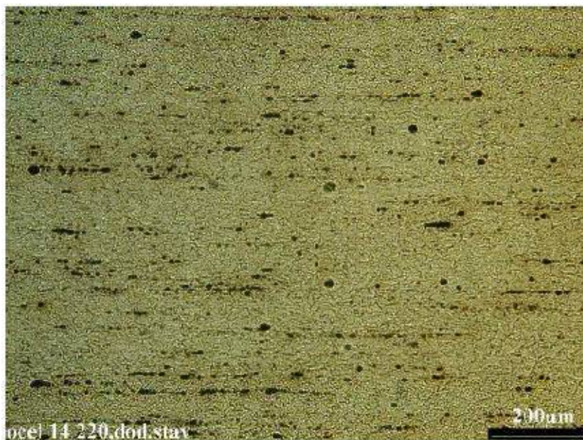
Obr. 2.1 - Struktura materiálu 16MnCr5 (14 220) zvětšení 100x [11].
