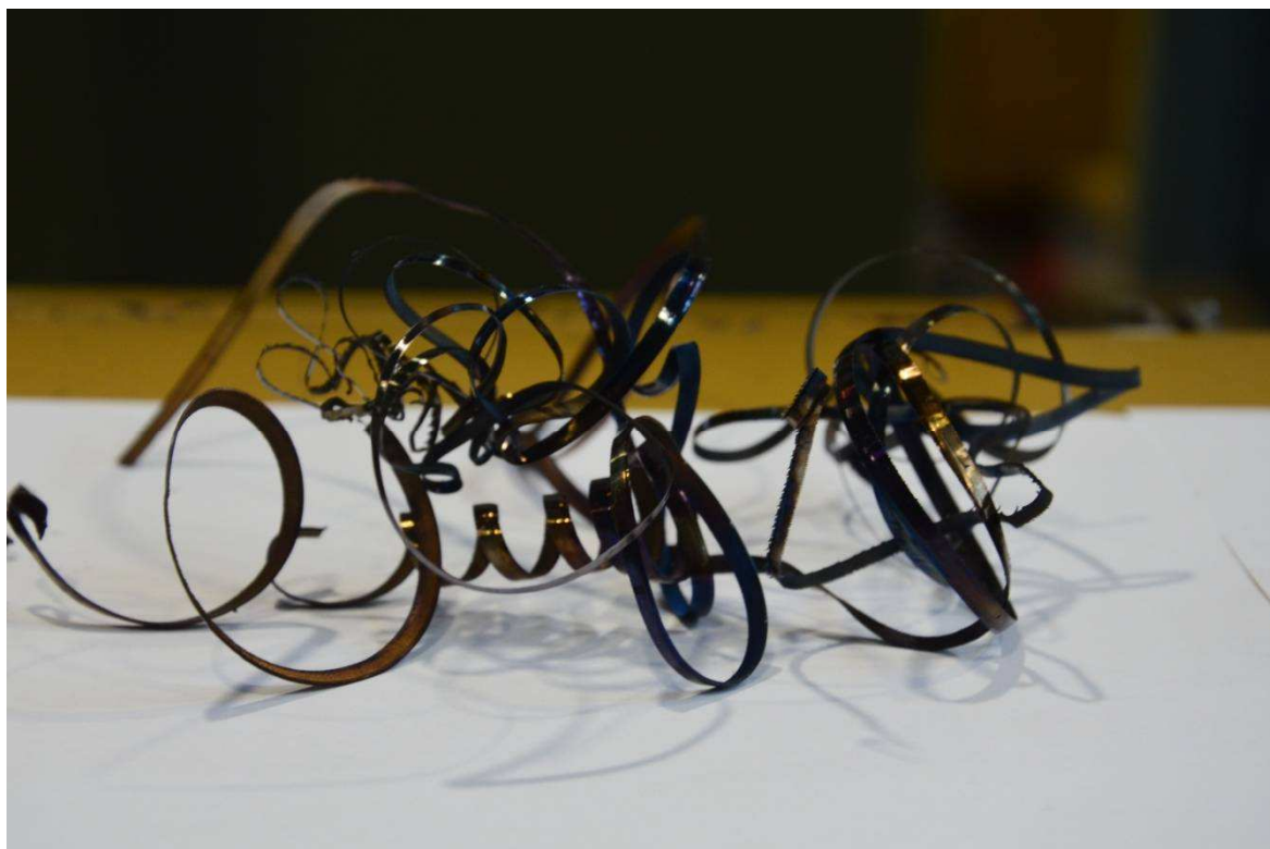
Obr. 2.23 - Vzniklá tříška při obrábění A_01_08 pravým nožem při a_p = 3,0 mm a f = 0,30 mm.
