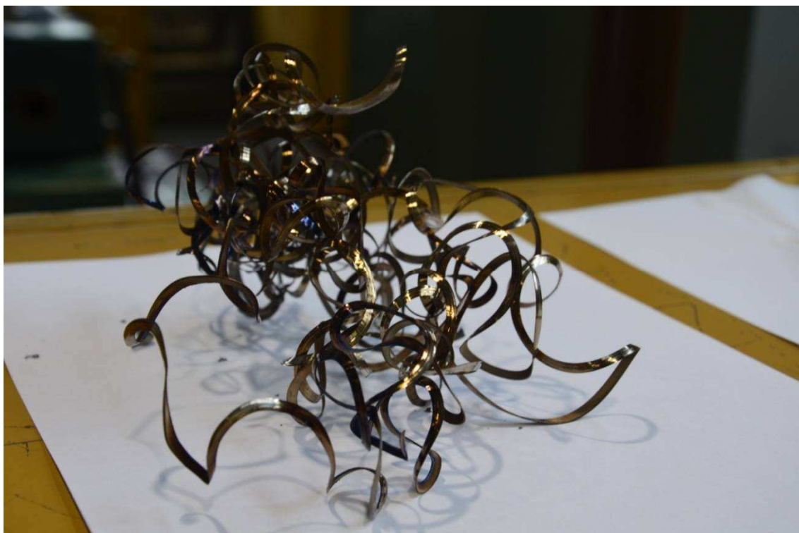
Obr. 2.26 - Vzniklá tříška při obrábění A_01_27 pravým nožem při a_p = 2,5 mm a f = 0,27 mm.
