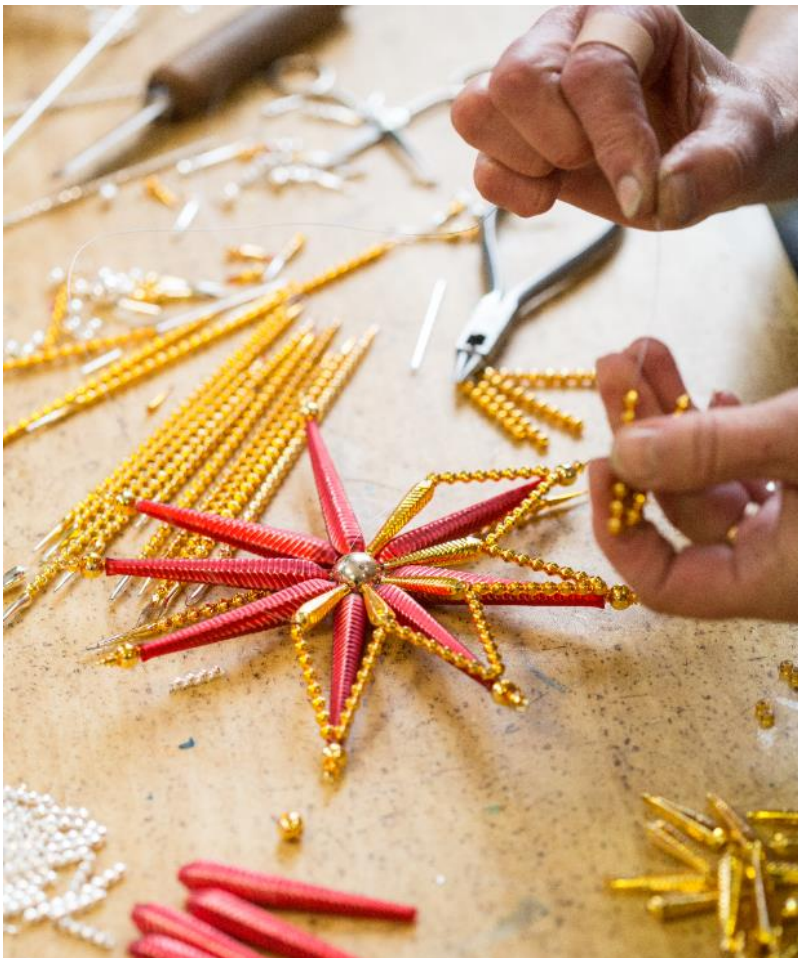
Obrázek 19: Montáž perliček do motivu vrcholové vánoční hvězdy
