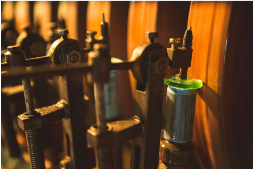
Obrázek 11: Broušení hran jednotlivých knoflíků
