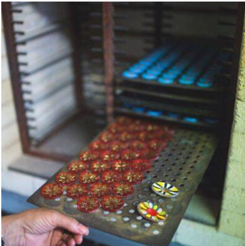
Obrázek 13: Zapékání barev v peci
