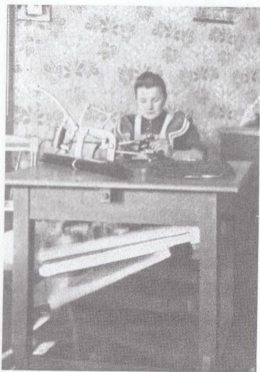
Obrázek 4: Výroba foukaných perlí pomocí Pitzekova strojku 1908,
