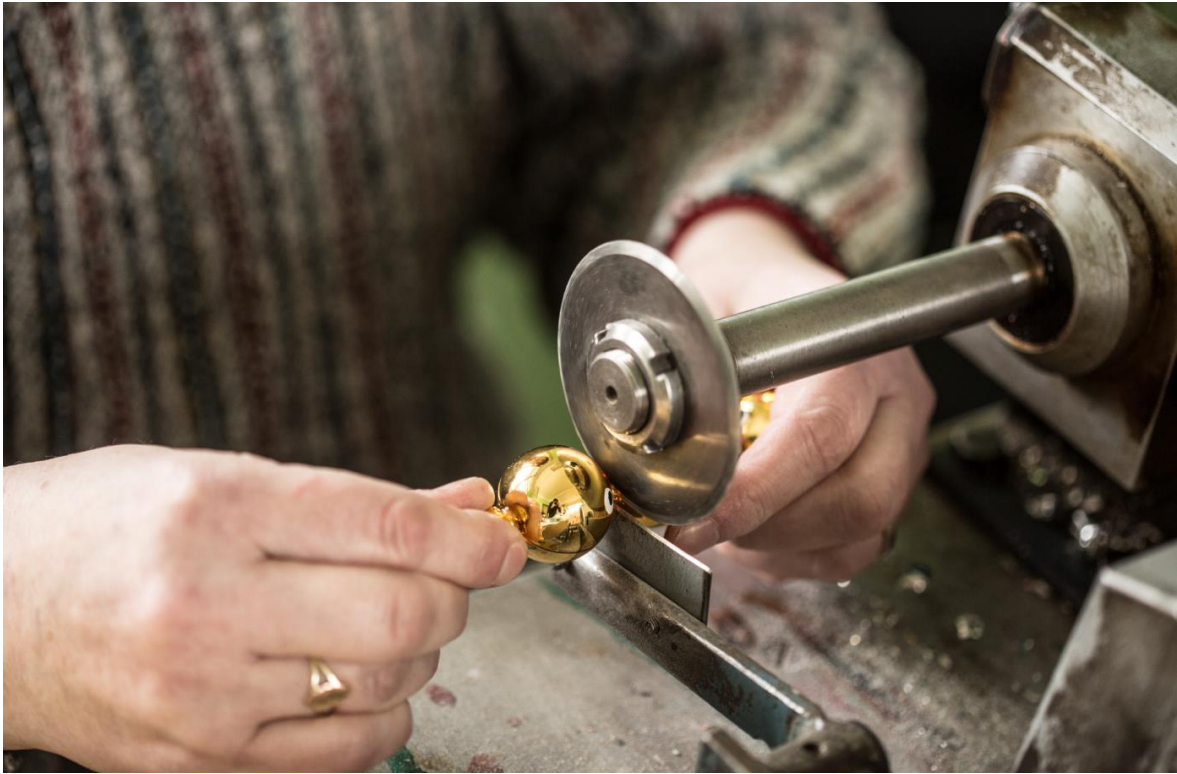
Obrázek 18: řez klaučat na jednotlivé perle
