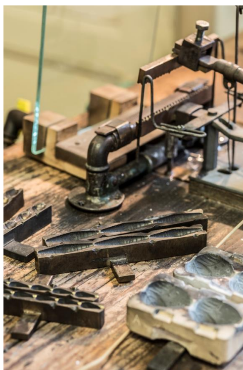
Obrázek 4: Výroba foukaných perlí pomocí Pitzekova strojku 1908,
