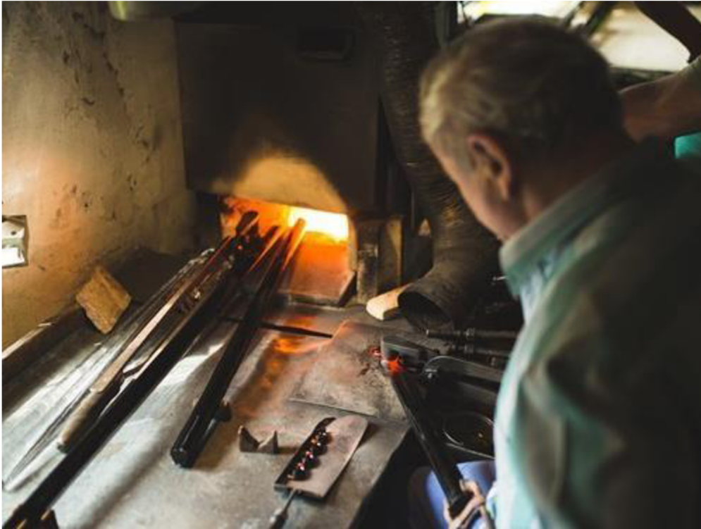
Obrázek 10: Mačkání skleněných knoflíků v dílně ve Smržovce
