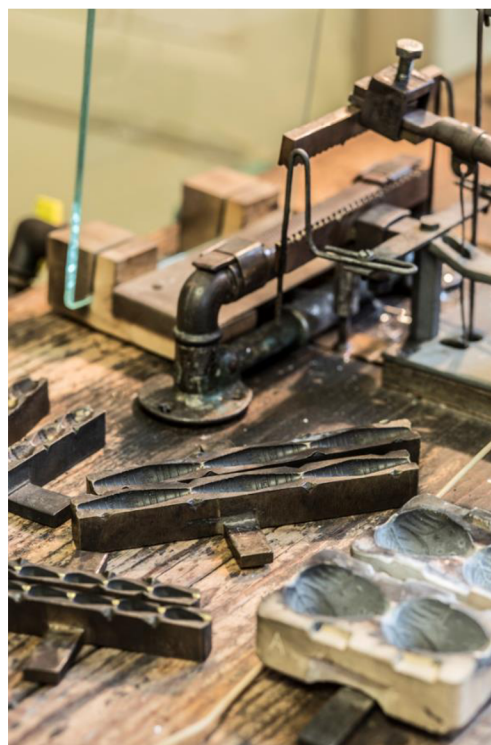
Obrázek 4: Výroba foukaných perlí pomocí Pitzekova strojku 1908,
