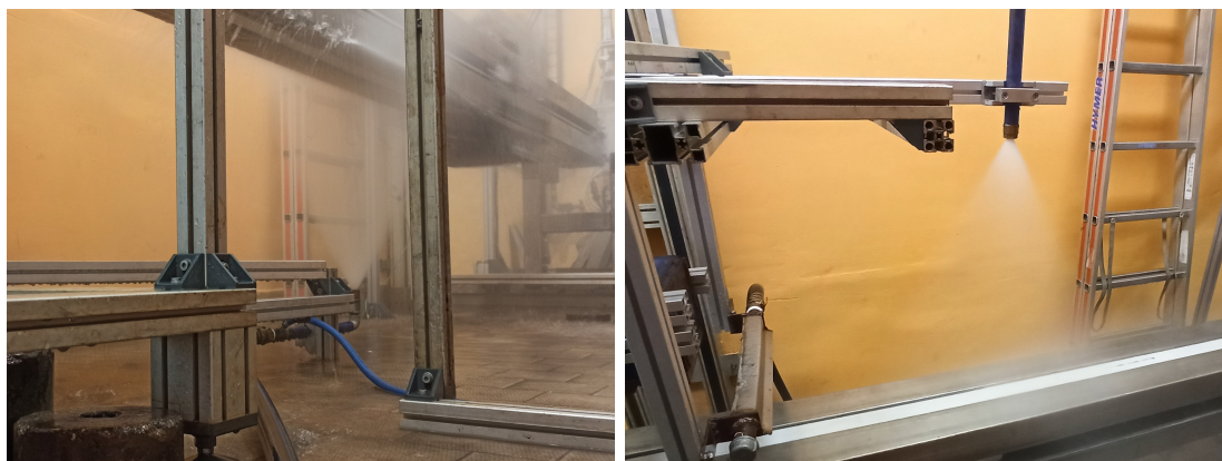
Obr. 6.18: Přívod vody do trysky; vlevo spodní chlazení, vpravo vrchní chlazení
