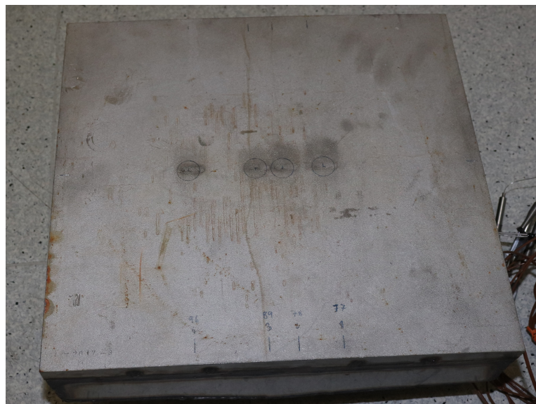
Obr. 5.2: Testovací deska s válcovaným povrchem
