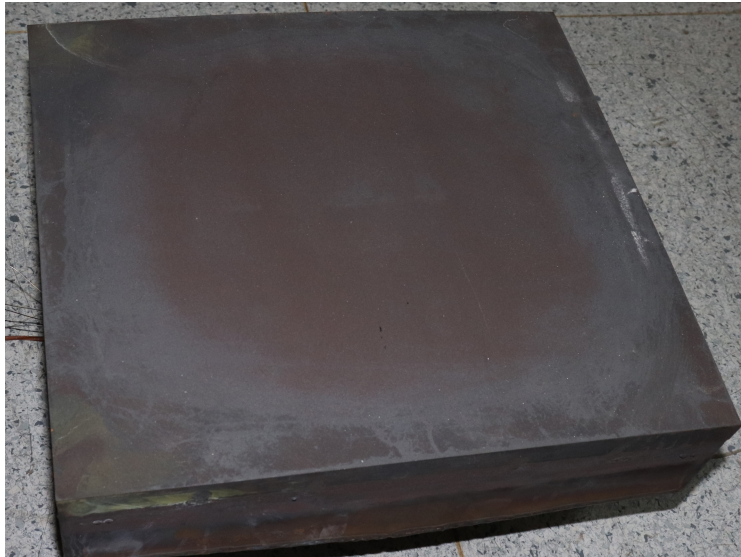
Obr. 5.3: Testovací deska se zoxidovaným povrchem
