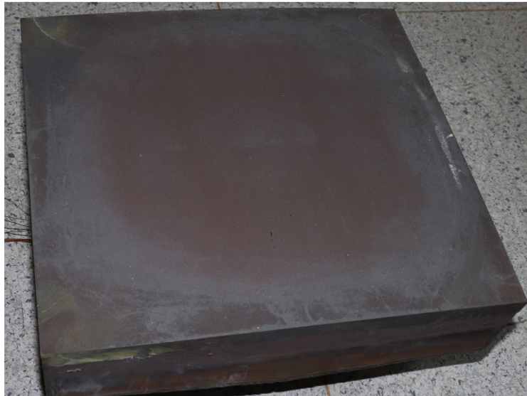
Obr. 5.3: Testovací deska se zoxidovaným povrchem
