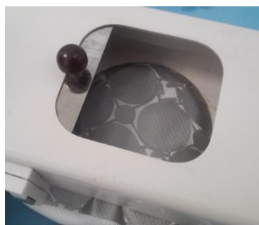
Obrázek 58 Zobrazení umístění vzorku do přístroje PERMETEST.
