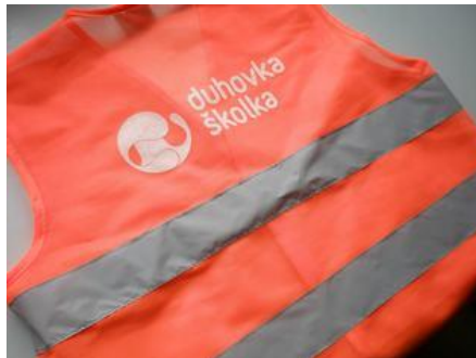
Obrázek 14 Ukázka reflexního potisku pomocí technologie sítotisku [22].
