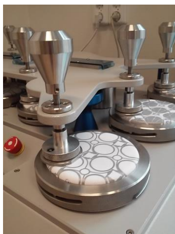
Obrázek 77 Upnutí vzorků do odírací textilie.
