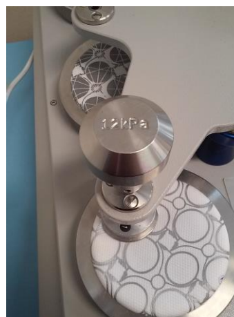
Obrázek 78 Upnutí vzorku, detail na použité závaží 12kPa.
