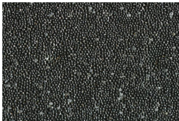
Obrázek 46 Makroskopický snímek 3M fólie aplikované pomocí transférového tisku.
