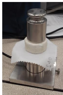
Obrázek 23 Umístění vzorku na čidlo přístroje. Zajištěno závažím a polystyrenem.
