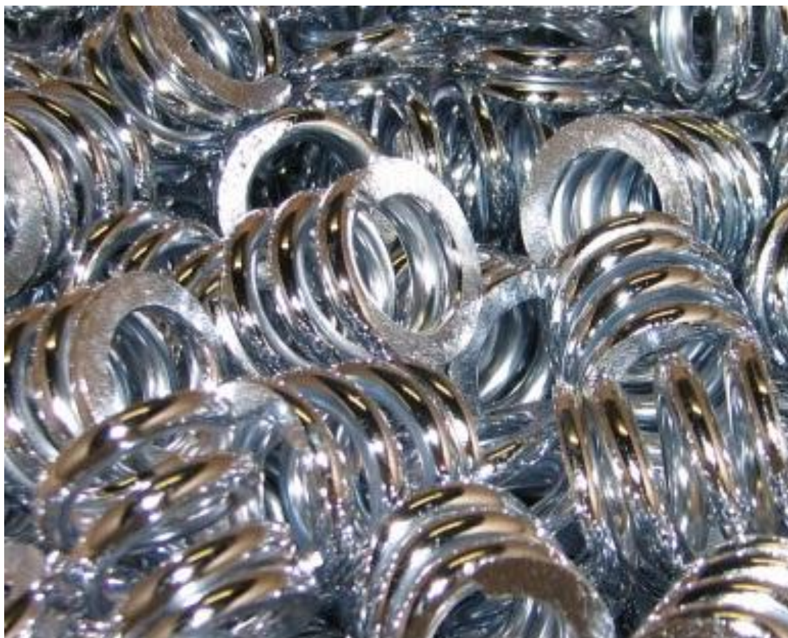
Obr. 1: Součástky upravené galvanickým zinkováním [2]
