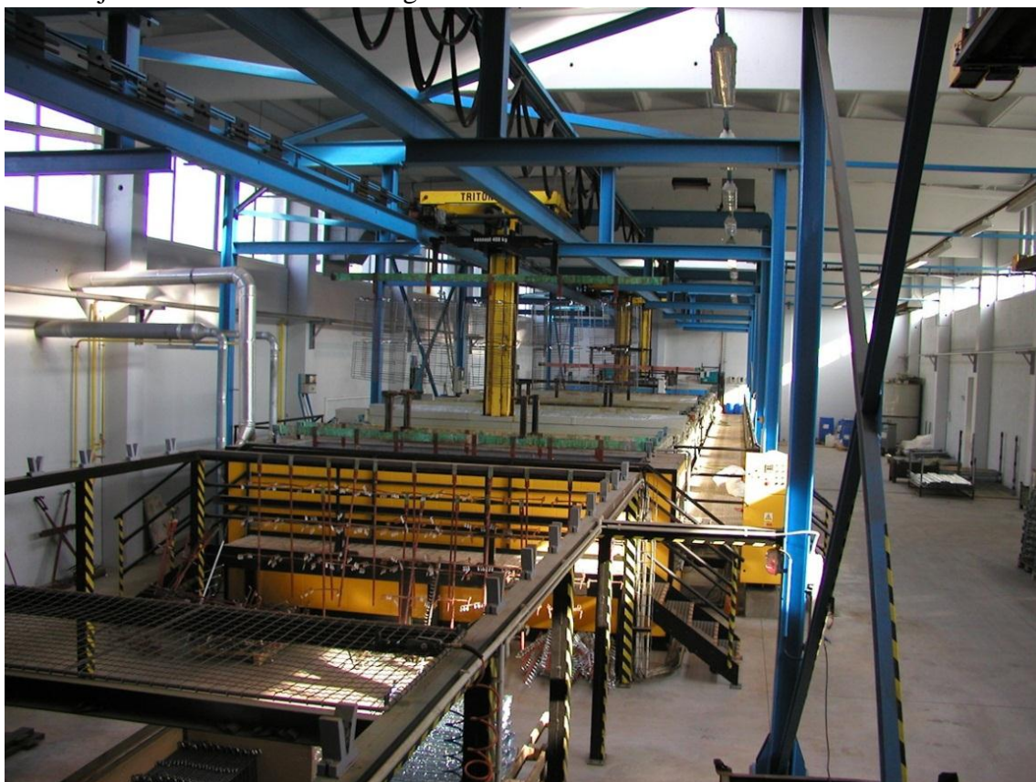
Obr. 7: Automatická galvanická linka
