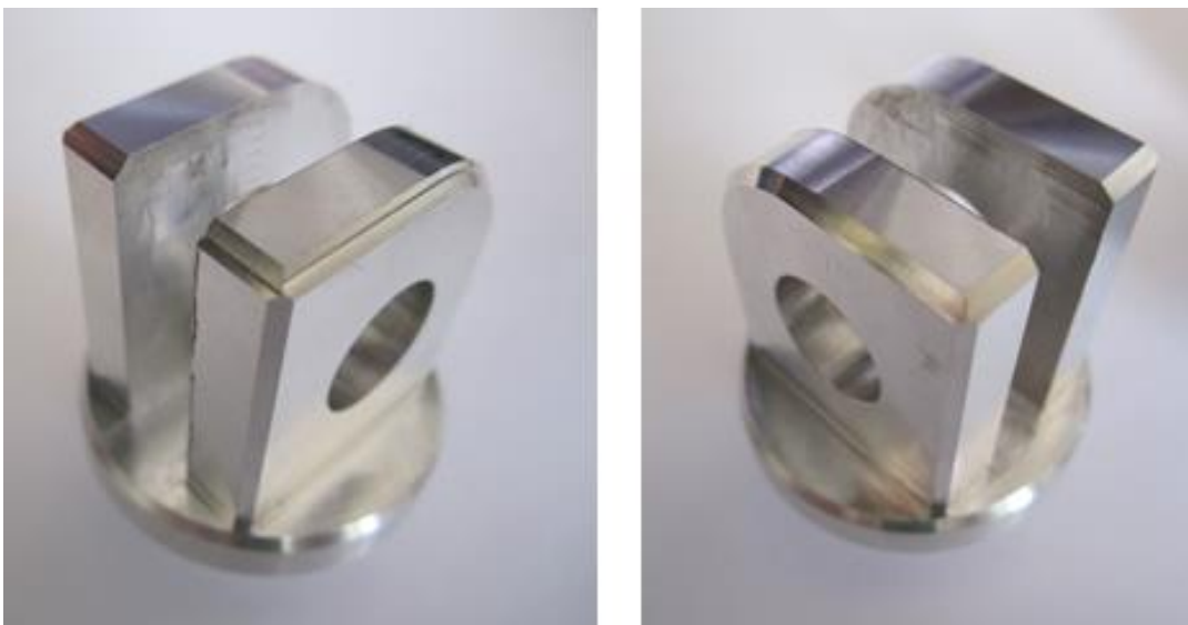
Obrázek 19: Špatné a správné sražení hran
