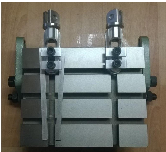
Obrázek 26: Upnutí stupaček na naklápěcí stůl
