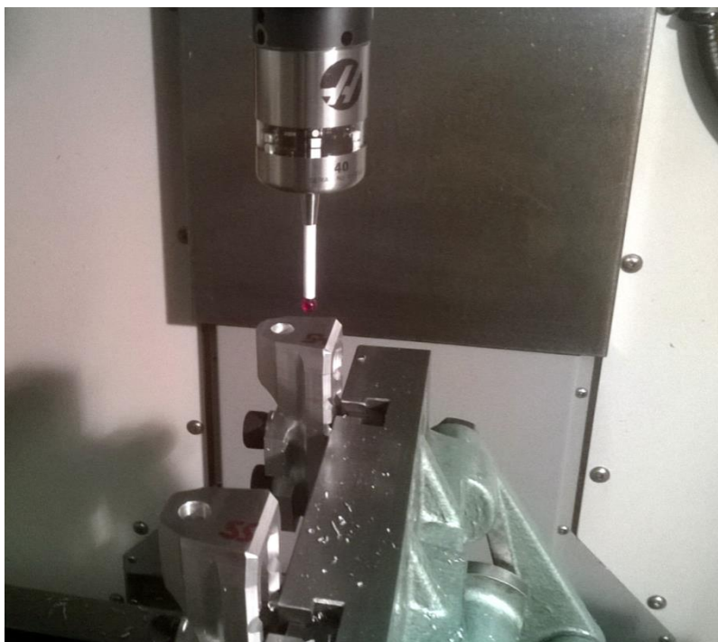
Obrázek 28: Měření nulového bodu
