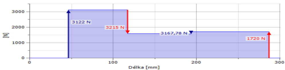
Obrázek 21 – Průběh reakcí na výstupním hřídeli, první rychlostní stupeň
