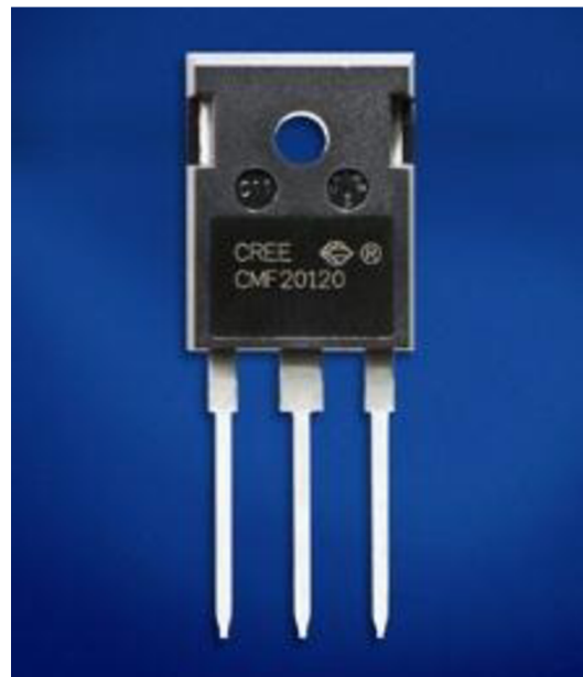
Obrázok 1.4 : Model tranzistora SiC MOSFET [4] a tranzistor CREE CMF-20120 [6]
