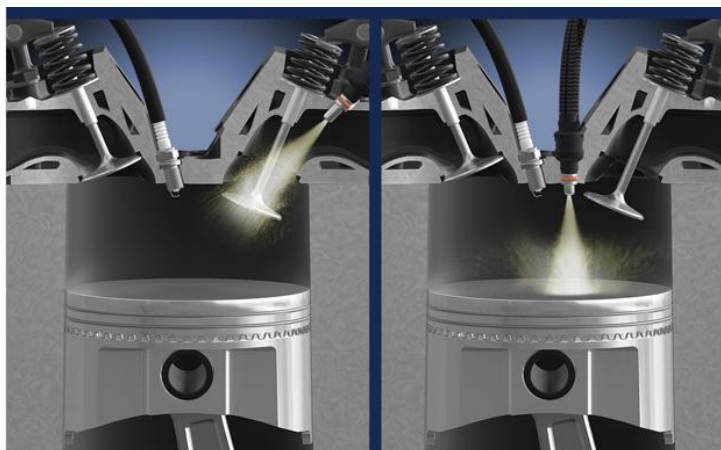
Obr. 1 Rozdíl mezi nepřímým a přímým (GDI) vstřikováním [2]
