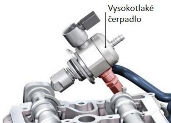
Obr. 25 Umístění a zdroj pohybu pístku vysokotlakého čerpadla u motoru TSI EA888 [37]
