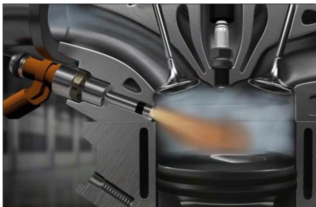
Obr. 2 Konstrukce spalovacího prostoru přímého vstřikování benzínu [10]
