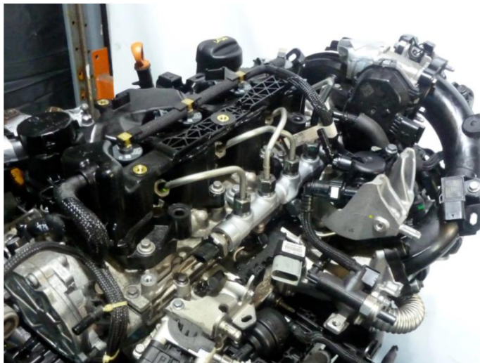
Obr. 36 Pohled na palivovou lištu a snímače tlaku paliva motoru 1.5 BlueHDI [53]
