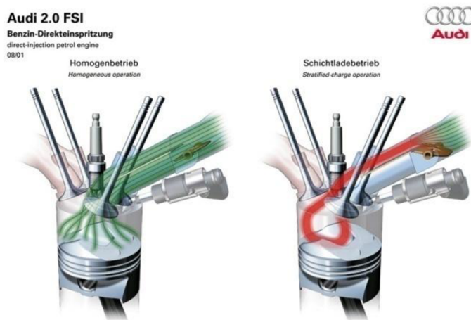
Obr. 3 Spalování při vysoké zátěži (vlevo) a při částečném zatížení (vpravo) [11]
