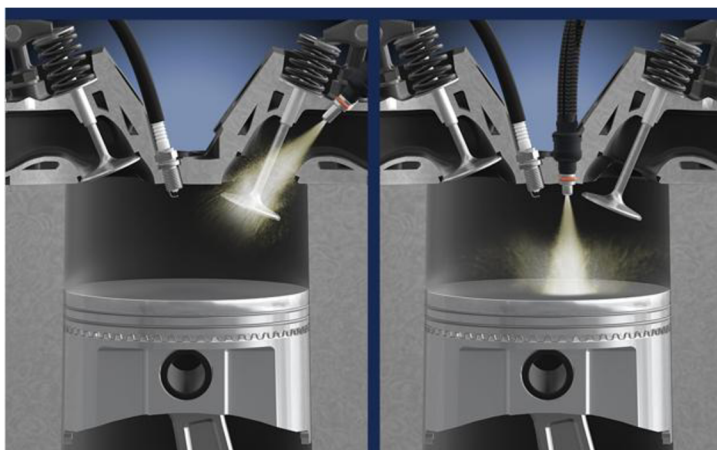
Obr. 1 Rozdíl mezi nepřímým a přímým (GDI) vstřikováním [2]
