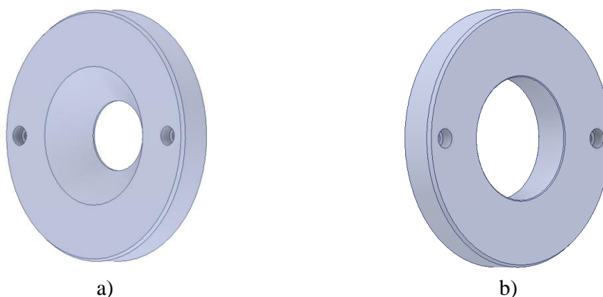
Obr. 19 Středicí kroužky: a) pevné poloviny, b) pohyblivé poloviny.
