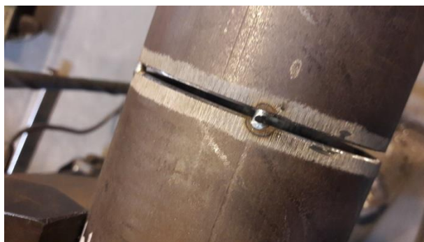
Obr. 12 Úprava stehových svarů
